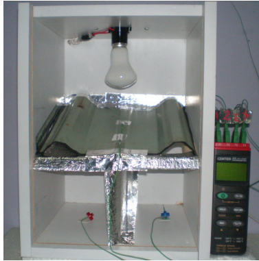
蓋上烤漆浪板 模擬鐵皮屋頂
