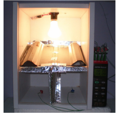
接上電源 利用燈泡熱源持續加熱 每 5 分鐘紀錄溫度變化
